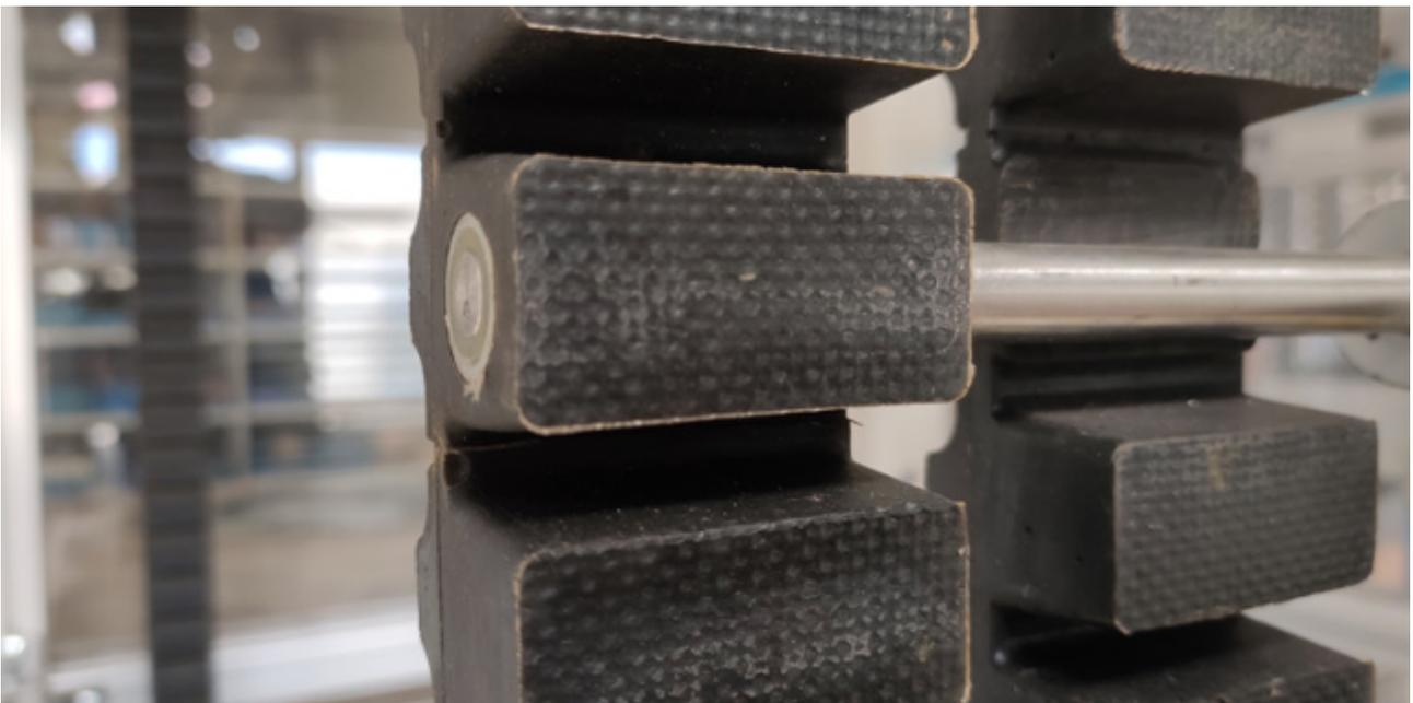
料斗把物料从下面的储藏中舀起，随着输送带或橡胶链条提升到顶部，绕过顶轮后向下翻转，斗式提升机将物料倾入接受槽内。带传动的斗式提升机的传动带一般采用橡胶链条，装在下或上面的传动滚筒和上下面的改向滚筒上。链传动的斗式提升机一般装有两平行的传动链，上或下面有一对传动链轮，下或上面是一对改向链轮。链轮和链轮上的相关零件可以保持良好的运行特性，并且可以在恶劣条件下或高速下保持可靠性。橡胶接头利用均匀地固定在环形牵引构件上的一系列料斗来垂直提升物料连续输送机械。如果橡胶接头链条在使用过程中被拉长，则需要将其切断。切割链在同面上，因此切割的数量是奇数，这将确保端部链节在同面上，并且须切割链。切断以避免与其他链接接触。另外，当控制操作时，圆形钢链的接头在表面上被淬火并且不能被。橡胶材料可应用于战机、坦克橡胶零件；潜艇吸声瓦。南通C型连续式提升机橡胶链条哪里有
